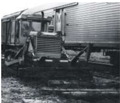
Рис. 5. Машина для прибирання шпал (автори розробки – Стефанов Б.М., Козар Л.М. Анзін О.І.)
