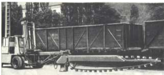
Рис. 3. Конвеєрний пристрій для вивантаження сипучих вантажів (автори розробки – Кривцов І.П., Залата О.М., Мироненко В.О., Мороз І.М., Правдюк М.Т.)
