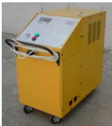
Рис. 18. Мобільна станція для тонкої очистки оливок – зліва; введення станції в експлуатацію на збагачувальній фабриці Полтавського ГЗК – справа (автори розробки – Лисіков Є.М., Косолапов В.Б., Воронін С.В., Літовка С.В.)
