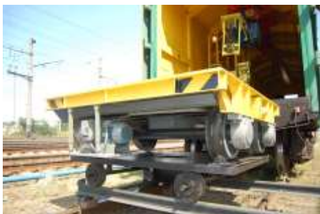
Рис. 9. Візок для перевірки вагонних ваг (автори розробки – Романович Є.В., Афанасов Г.М.)
