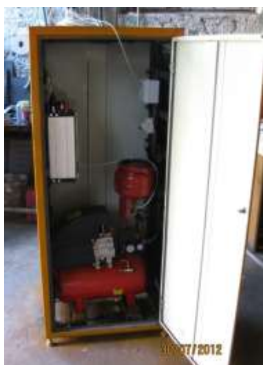
Рис. 19. Стаціонарна система змащування рейок: загальний вигляд – зліва; станція в тунелі метро – справа (автори розробки – Лисіков Є.М., Воронін С.В., Стефанов В.О., Онопрейчук Д.В., Літовка С.В.)
