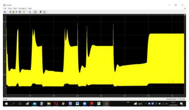
Рис. 20. Графік зміни оптимальної постійної часу адаптивного фільтра T_{opt}(Q, R, T_{\sigma}) за наявності завод змінної інтенсивності
