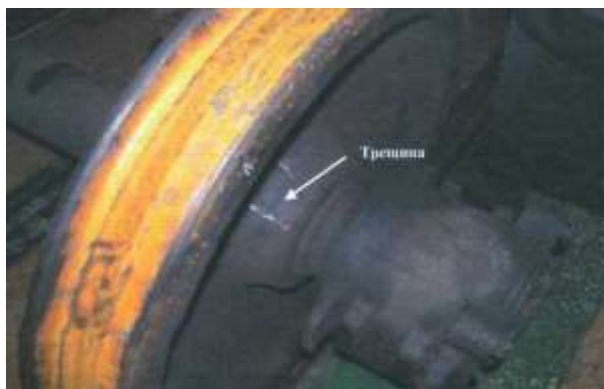
Рисунок 1 - Тріщини, що виникли в процесі експлуатації
