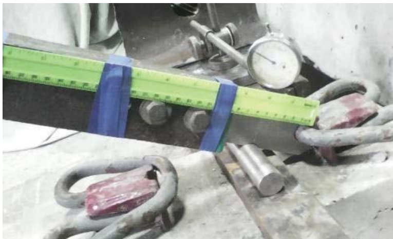
Рис. 1. Обладнання для випробування клем КПТ
