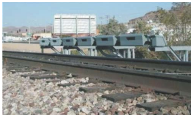
Рис. 3 – Масив мікрофонів системи TADS акустичного контролю стану рухомого складу
