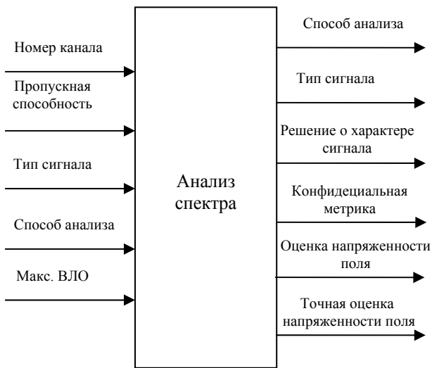
Рис. 2. Обобщенная структурная схема мониторинга спектра
