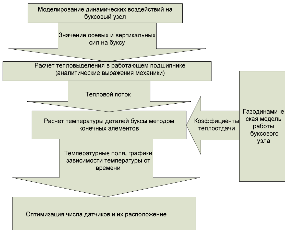
Рисунок 1 – Структурно-логическая схема решения задачи размещения датчиков тепловой диагностики букс.
