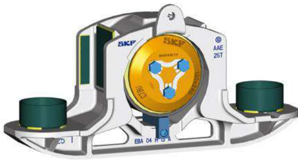
Рис. 10. Буксовий вузол SKF
