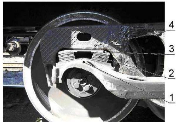
Рис. 14. Буксовий вузол з адаптером, інтегрованим у "важіль Шеффеля"
