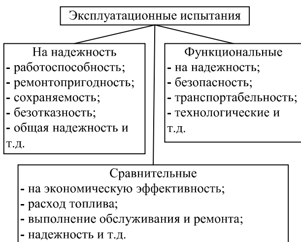
Рис. 1. Классификация усовершенствованных эксплуатационных испытаний подвижного состава
