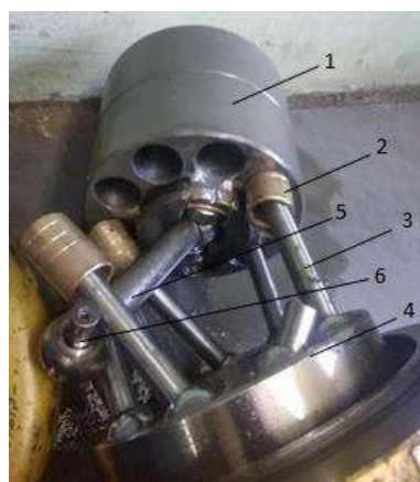
1 – блок циліндрів; 2 – поршень; 3 – шатун; 4 – шайба; 5 – карданний вал; 6 – палець карданного вала
