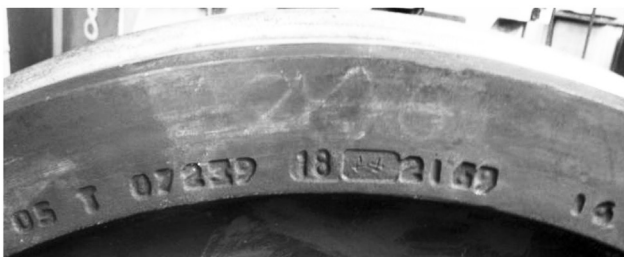
Рис. 49. Клейма и знаки маркировки, относящиеся к изготовлению колеса: 1 – две последние цифры года изготовления колеса; 2 – марка стали; 3 – номер плавки; 4 – условный номер предприятия-изготовителя колеса (номер или его торговая марка); 5 – приемочные клейма; 6 – порядковый номер колеса по системе нумерации предприятия-изготовителя; 7 – код государства-собственника колеса, наносимый на площадках в двух местах: первое клеймо – на расстоянии 100–150 мм от основной маркировки, второе – с противоположной стороны
