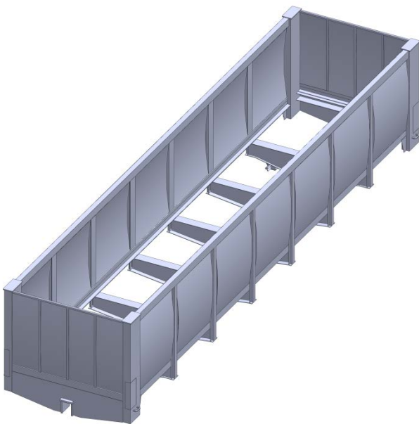
Рис. 2 – Несівна конструкція напіввагона з випуклими стінами
