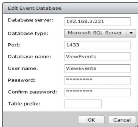
Рисунок 2.25 – Підключення Events DB до Horizon View
