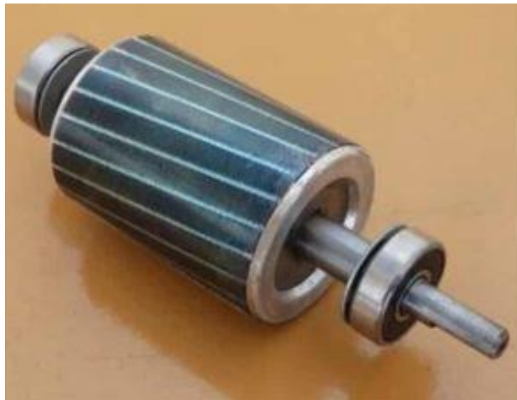
Рисунок 14 – Зовнішній вигляд короткозамкненого ротора АД
