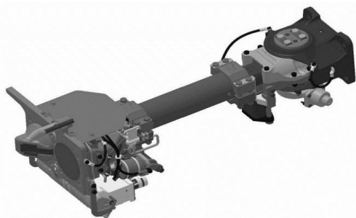
Рис. 6. Автоматична автозчепна система типу Шарфенберга поїзда HRCS2 виробництва компанії «Hyundai Rotem»
