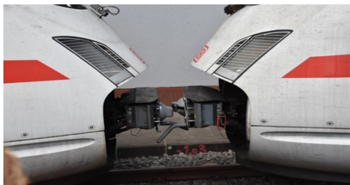
Рис. 2. Приклад готовності до з'єднання двох модулів поїздів ICE T за допомогою шарфенберзького з'єднувача
