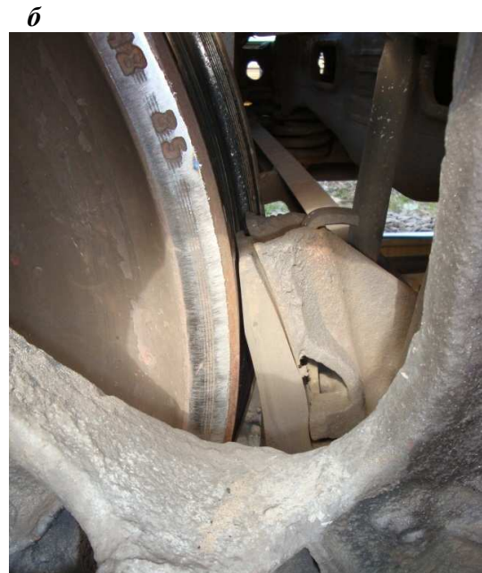
Рис. 1. Клинодуально зношені гальмові колодки: а – з верхньою шкідливою стертістю; б – за взаємодії верхнього кінця з поверхнею кочення колеса під час руху вагона
