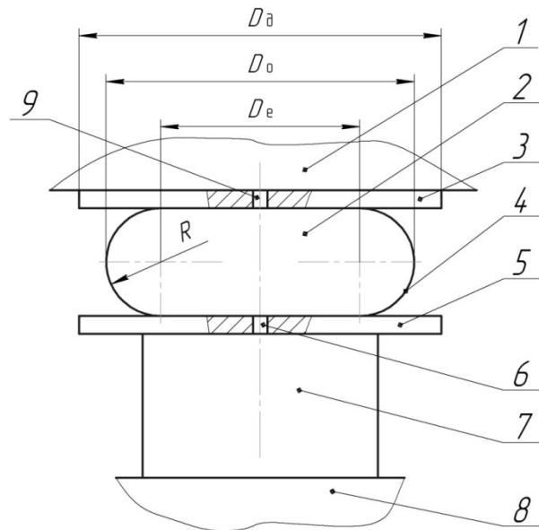
Проведено порівняльне дослідження шляхом імітаційного моделювання, із використанням програмного комплексу MATLAB Simulink, динаміки транспортного засобу із двома типами пневматичних ресор: діафрагмовою та балонною.. Підвіска із запропонованою балонною пневморесорою забезпечила затухання коливань менш, ніж за два періоди, тобто коефіцієнт демпфірування досягав 0,28, що наближено до рекомендованого для транспортних засобів, а при діафрагмовій пневморесорі він складав не більше, ніж 0,12.
