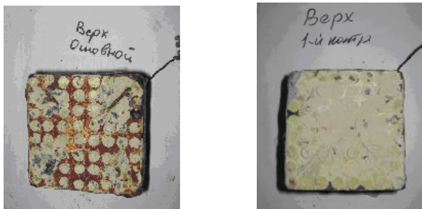
Рис. 12. Поверхность верхней грани основного образца (слева) и контрольного №1 после удаления электродов
