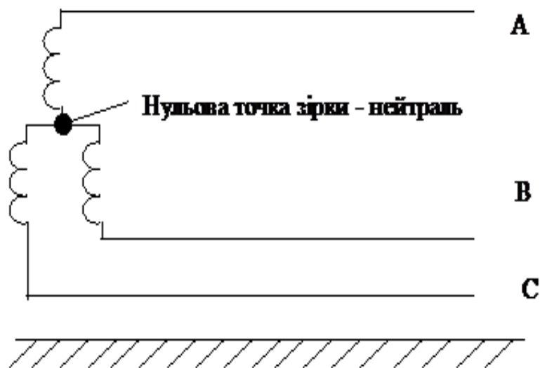
Рисунок 2.1 – Типова схема електричної мережі з ізолюваною нейтраллю
