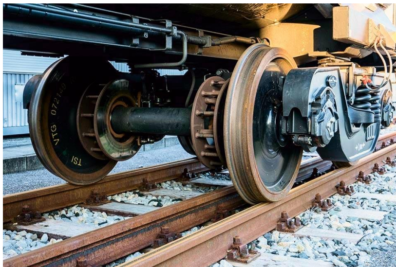
Рисунок 8.3 – Візок RC25NT компанії Eisenbahnlaufwerke Halle з радіальною установкою колісних пар і полегшених дискових гальм виробництва Faiveley
