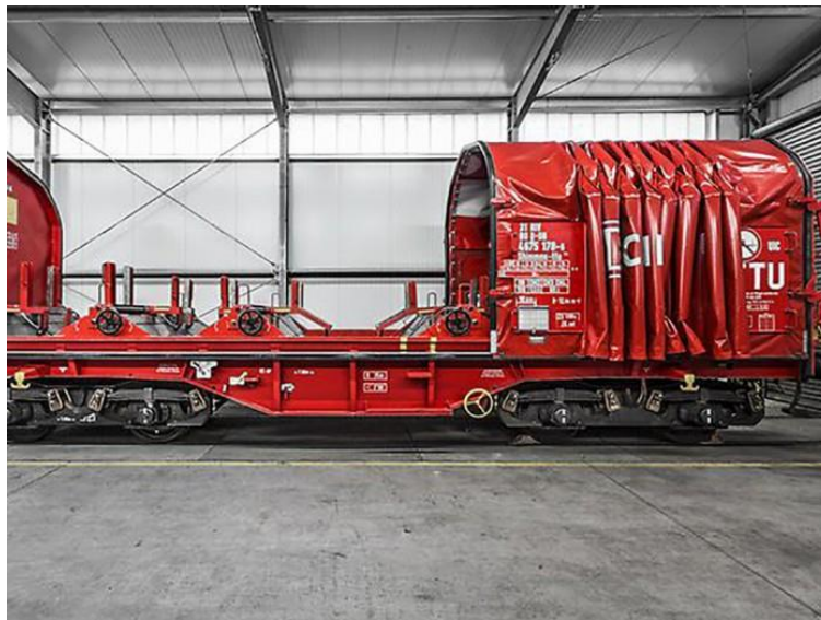
Рисунок 1.2 – Вагон для перевезення сталі для автомобільної промисловості зі спеціальним тентовим накриттям
