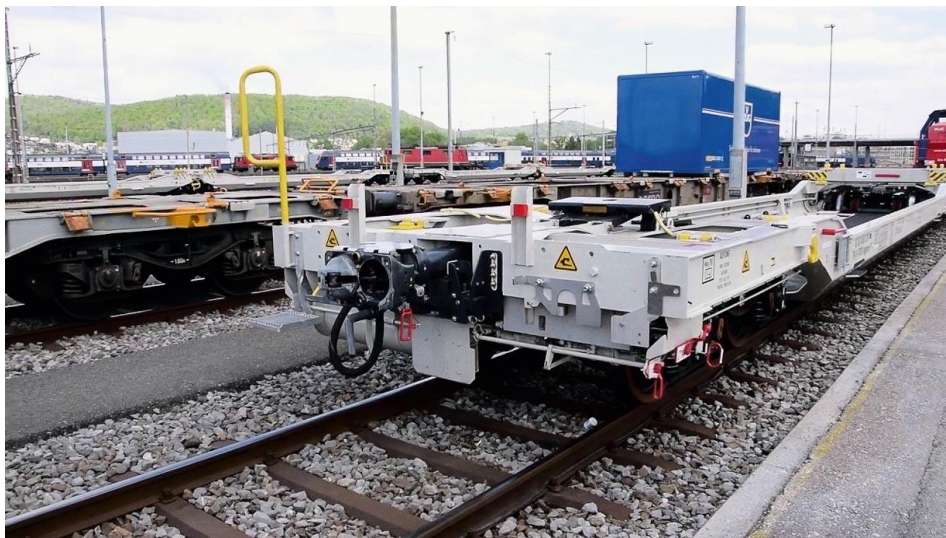
Рисунок 8.1 – Один із вагонів демонстраційного потяга 5L, обладнаний автозчепленням з автоматичним з'єднанням повітропроводів гальмової магістралі
