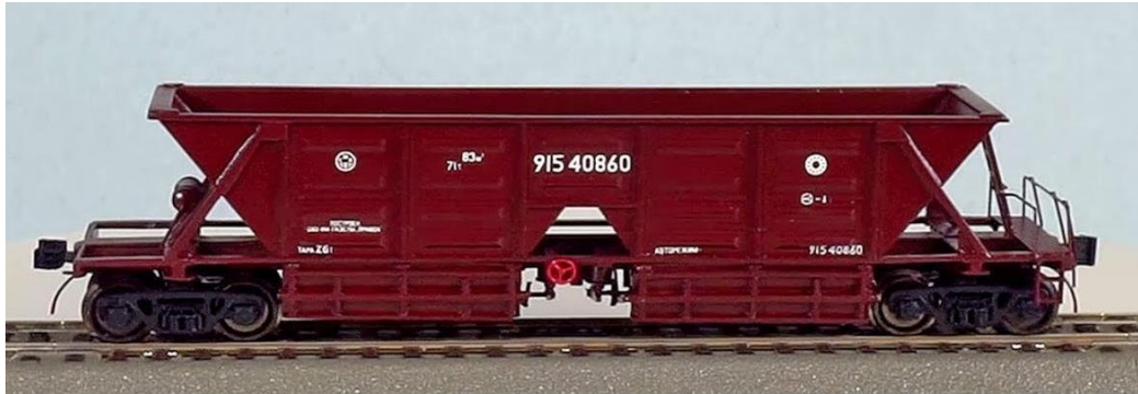
Рисунок 1.6 – Вагон-хопер для вугілля вантажопідйомністю 90 т (Модель 22-4003)
