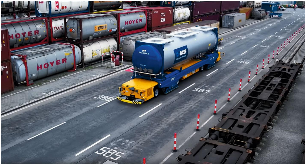
Рисунок 8.6 – Перевезення танка-контейнера в автоматичному режимі території підприємства в Дуйсбурі
