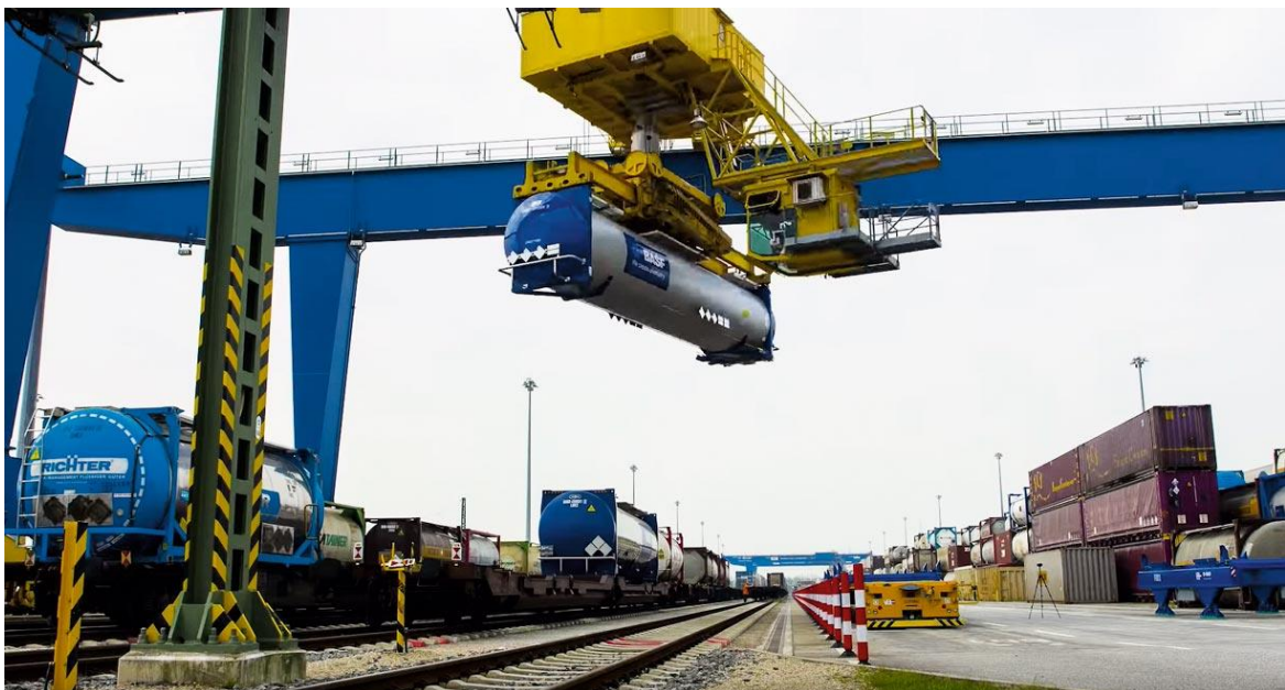
Рисунок 8.5 – Перевантаження інноваційного танка-контейнера компанії BASF на безпілотний транспортер
