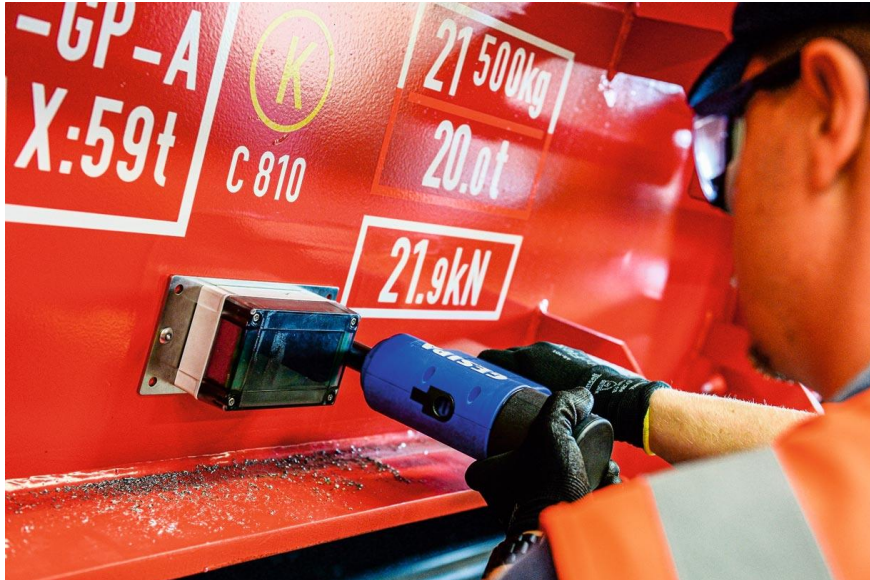
Рисунок 8.2 – Монтаж телематичного пристрою на вантажному вагоні
