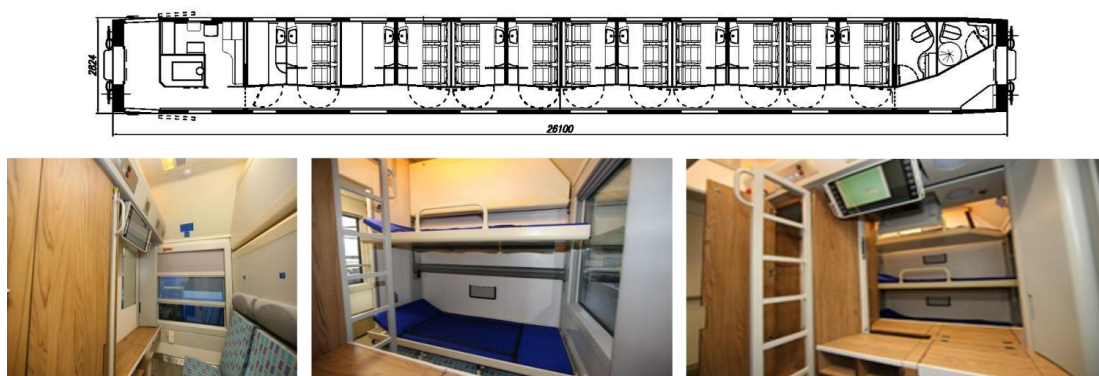
Рисунок 2.10 – Планування і виконання інтер'єру пасажирських вагонів для міжнародних сполучень (РІЦ) виробництва ПАО «КВСЗ»
