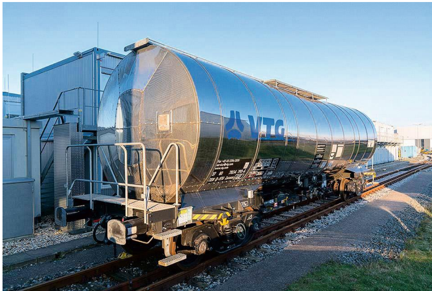
Рисунок 8.4 – Вагон-цистерна компанії VTG з полегшеним резервуаром збільшеного діаметра
