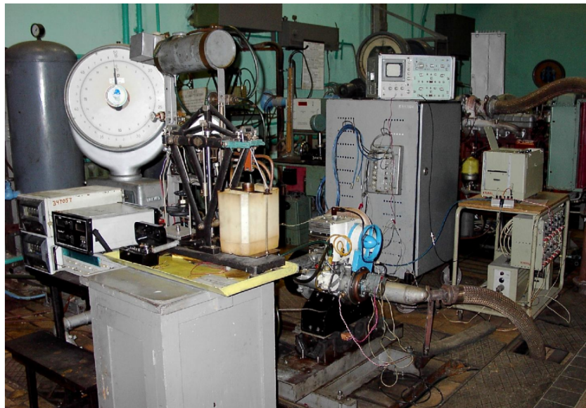
Рисунок 2 – Експериментальний стенд з двигуном ДН-4 та вимірювальною апаратурою
