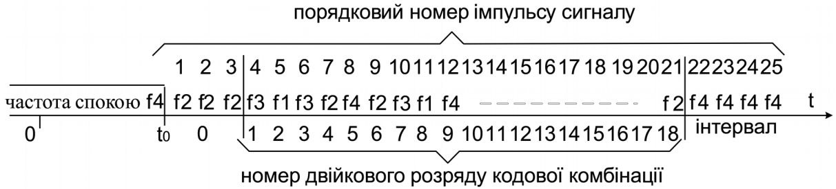
Рис. 5.5. Структура сигналу ТУ для ЛП з адресою 111000
