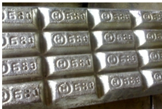
Рис. 3.14. Бабіти – підшипникові сплави, що відзначаються антифрикційними властивостями
