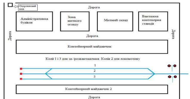
Рис. 1. Схема СП (термінал обслуговується навантажувачем)
