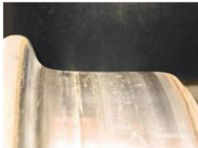
Рисунок 9.7 – Колесо з новим нелінійним профілем ІТМ-73
