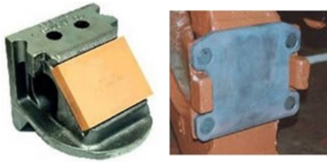
Рисунок 9.5 – Фрикційні клини з пружними поліуретановими накладками на похилих поверхнях і зносостійкі фрикційні планки
