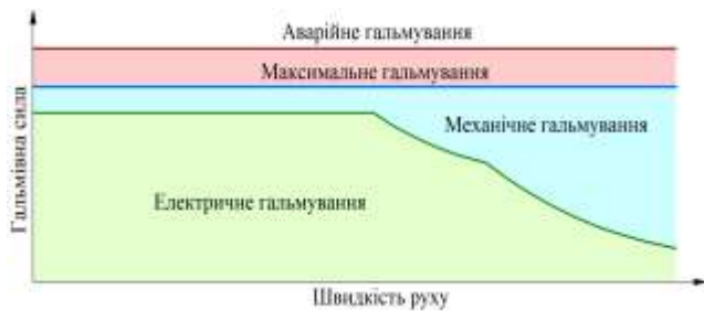
Рис. 1. Залежності сили гальмування від швидкості руху
