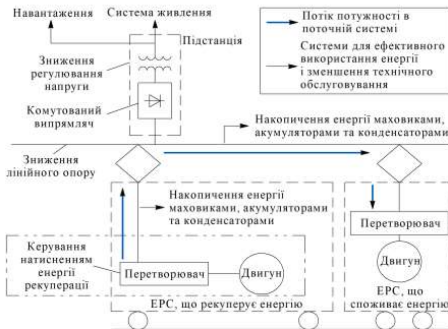
Рис. 2. Потік енергії під час рекуперативного гальмування
