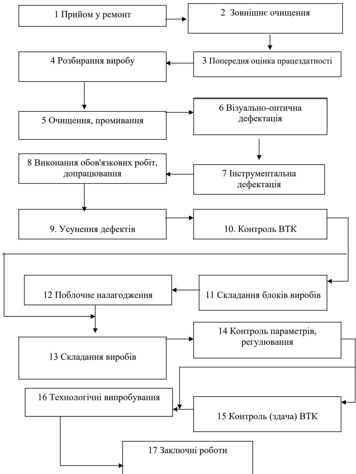
Рисунок 2 – Схема технологічного процесу, відповідного стратегії ремонту по напрацюванням (середній і капітальний ремонт)
