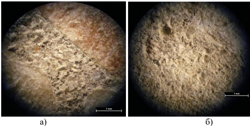
Рис. 4. Структура бетону при вмісті лещадних частинок у щебені 5 %: а) зона контакту; б) розчинна частина
