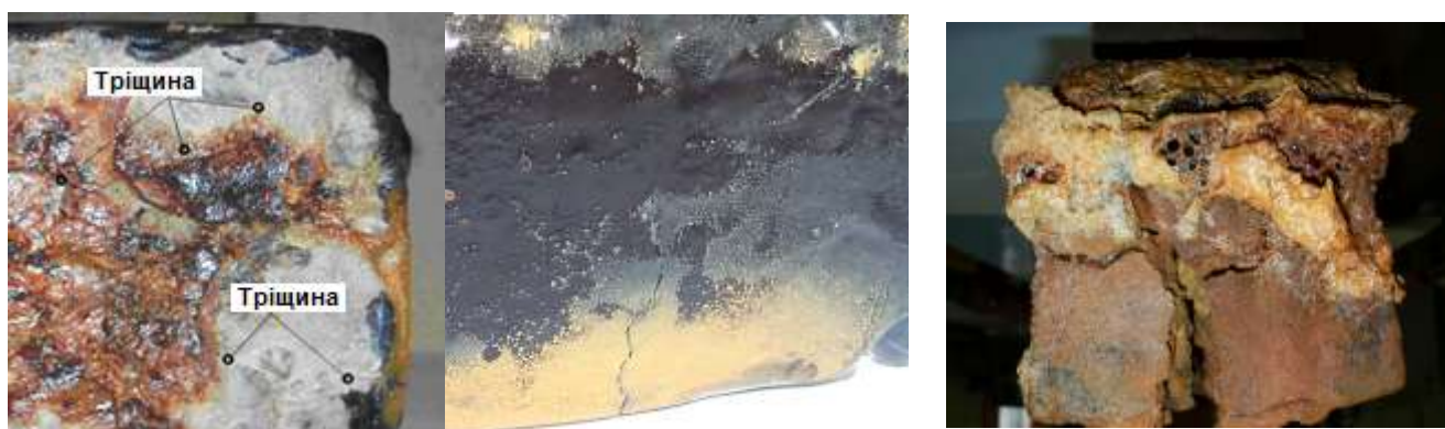
Рис. 6. Лабораторний зразок-основа: а) збільшений фрагмент з тріщинами після 400 годин обробки струмом; б) утворення тріщин на бічній грані зразка-основи; в) руйнування зразка-основи після 5000 годин обробки струмом
