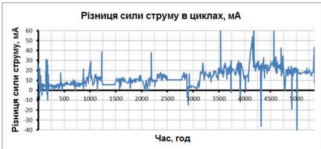
Рис. 5. Результати досліджень впливу ПОЕН у водонасиченому стані бетону протягом 5375 годин (17800 циклів): а) графік зміни сили струму в часі; б) графік різниці сили струму в циклах
