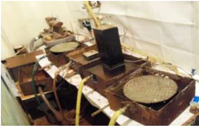
Рис. 7. Фото зразків під час обробки електричною напругою (а) і схема розташування електродів у призматичному зразку (б)
