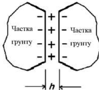
Рис.1. Схема подвійного електричного шару (ПЕШ) однойменно заряджених часток високодисперсної фази при незначному вмісті води в ній
