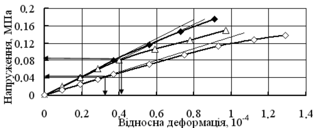
Рис. 2. Залежність напруження-деформація при температурі 20 °C і частоті 0,5 Гц асфальтобетонів типу Б на бітумах – \diamond БНД 90/130; \triangle БНД 60/90; і асфальтополімербетону на в'язучому – \blacklozenge БНД 90/130 + 3 % SBS
