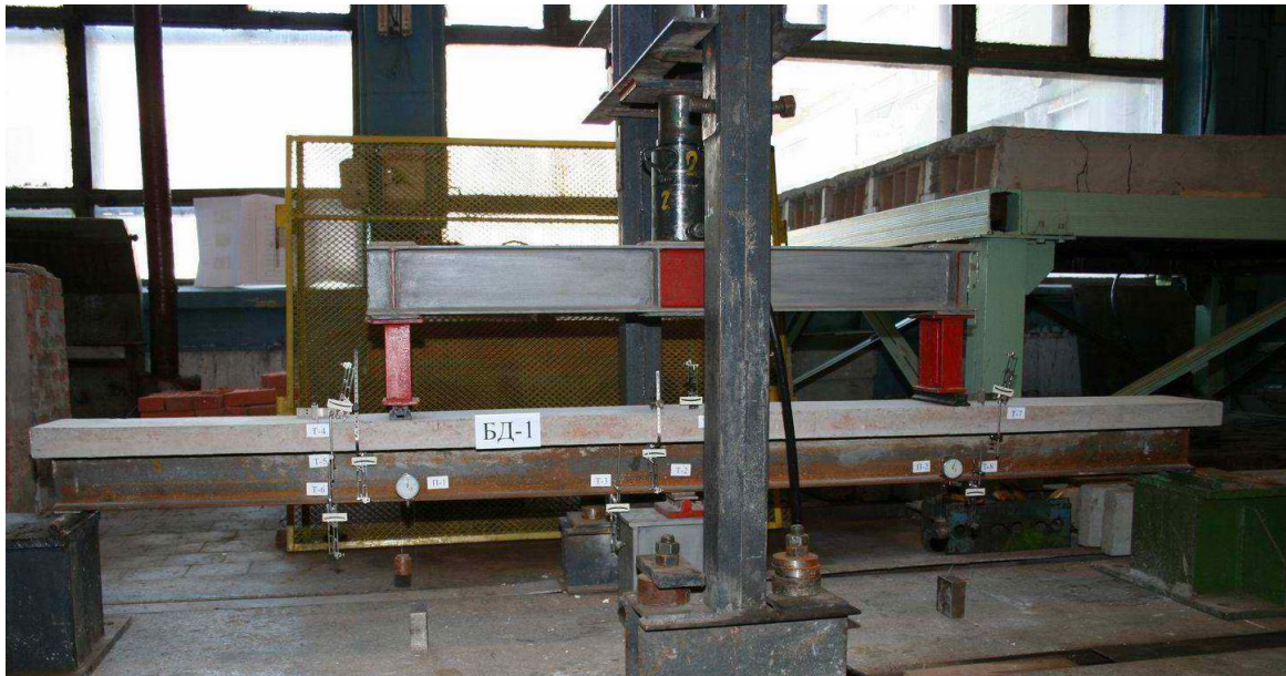
Рис. 4 Общий вид испытания двухпролетной сталежелезобетонной балки
