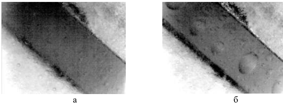
Рисунок 14 – Результати коалесценції води в гідравлічній оливі при обробці електричним полем: а – перед обробкою; б – після обробки
