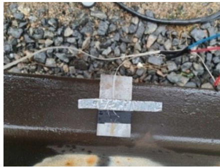
Рисунок 26 – Пластина з компенсаційним тензорезистором
