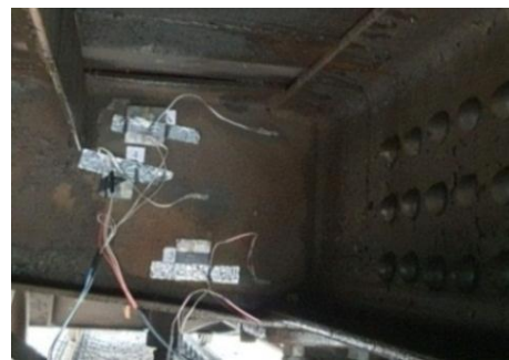
Рисунок 27 – Розміщення тензорезисторів на шворневій балці вагона-платформи: лівий вертикальний лист – а; правий вертикальний лист – б
