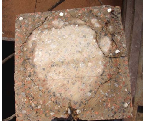
Рис. 6. Зовнішній вигляд перерізу колони після розрізання
