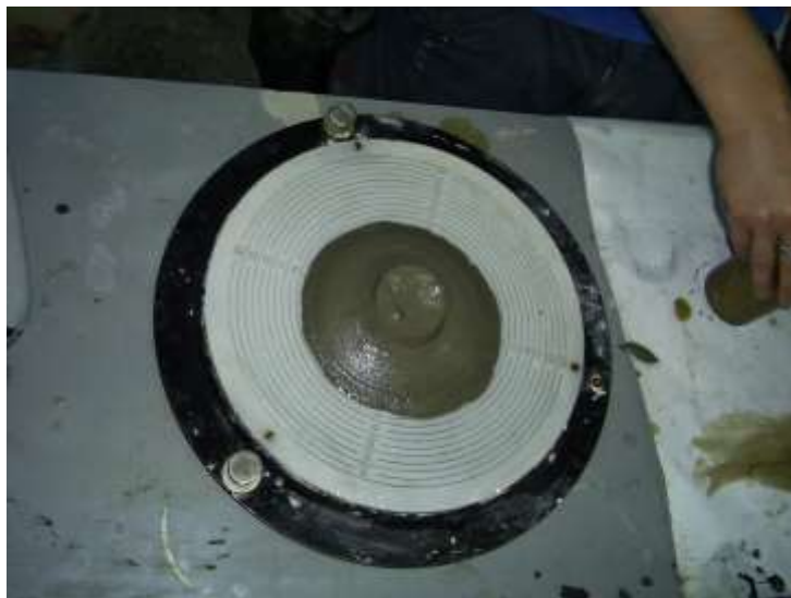
Рис. 1. Визначення розтічності суміші за віскозіметром Сутгарда
