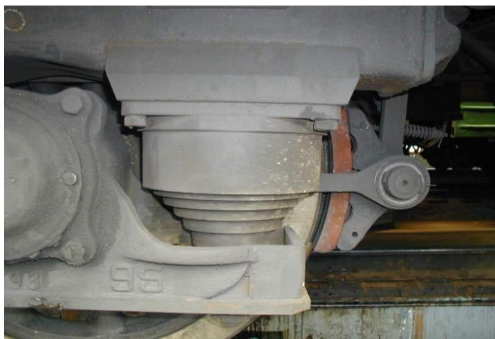
Рисунок 2.14 – Модернізований буксовий вузол візка електропоїзда з гідрофедером
