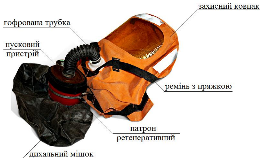
Рис. 6.4. Конструкція саморятівника промислового ізолюючого СІІ-20
